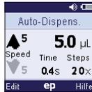
In den Modi **Dis** und **Ads** wird die aufgenommene Flüssigkeit in definierten Einzelschritten abgegeben.
