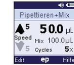
Zusätzlich werden im Display das Mischvolumen (**Mix**) und die Anzahl der Mischzyklen (**Cycles**) angezeigt.
