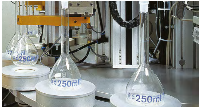
Maschinelle Bedruckung von Messkolben
