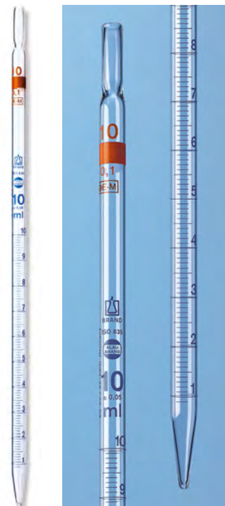
Messpipette Typ 2, Nennvolumen oben
