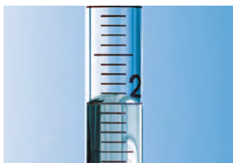
Nach oben gekrümmter Meniskus in einer Messpipette.
