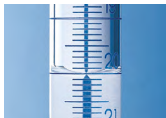
Abbildung des Meniskus am Schellbachstreifen in einer Bürette.
